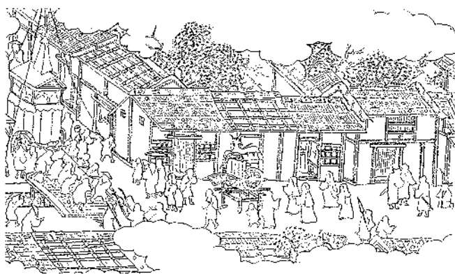
図3 マチヤの幾構え。鳥居型の口に暖簾がたれており、その奥に土間がみえ、その脇に床がみえ、角にたつマチヤの妻面には棟持柱がみえる（リライト：洛中洛外図屏風・東博模本・左巻2節より） 出典：土本俊和「京マチヤの原形ならびに形産生成」
