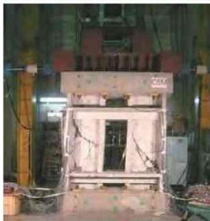
図13 耐震壁の性能評価実験
