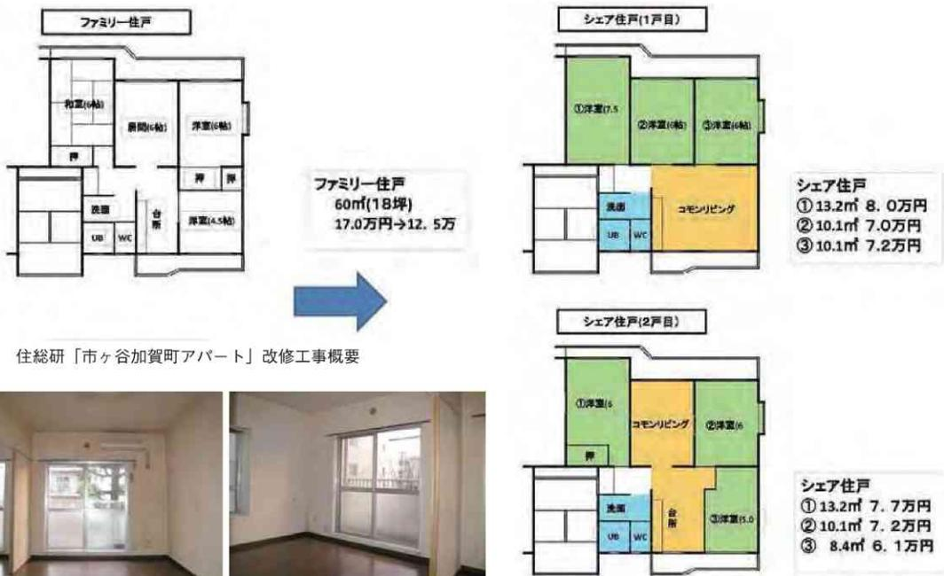
図2 住総研「市ヶ谷加賀町アパート」改修工事概要
