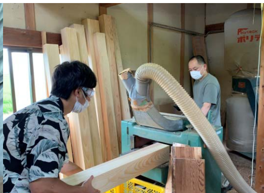
図7-1 秋岡木工所と大型角ノミ機・自動カンナ(2021.7.18)
