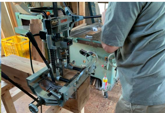
図7-1 秋岡木工所と大型角ノミ機・自動カンナ(2021.7.18)
