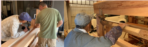
図7-9 共同作業,コテ・指竹と足踏み取り付け(2021.10.3~23)
