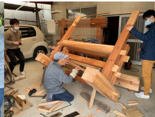
図3-5 前・後柱の本組と踏み木束の取り付け(2021.3.29)
