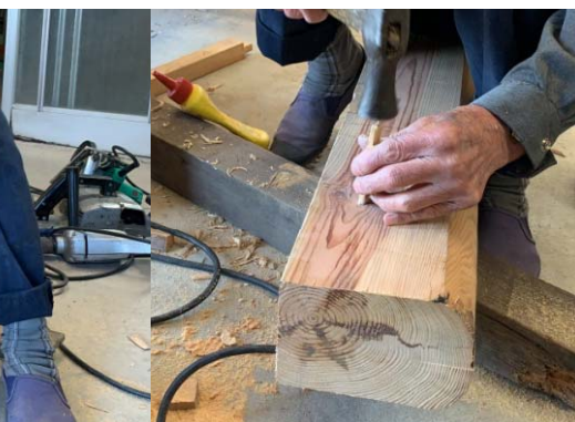
図3-6 笠木の加工と取り付け(2021.4.1)
