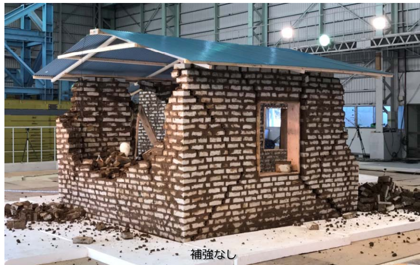
JMA神戸70%加振後の試験体状態(補強なしモデル)
