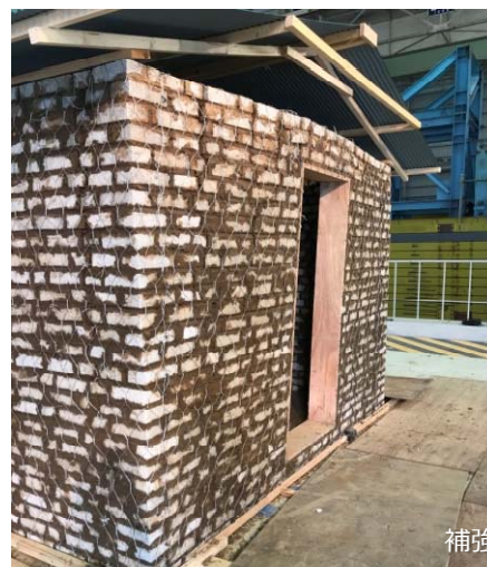
JMA神戸70%加振後の試験体状態(補強モデル)
