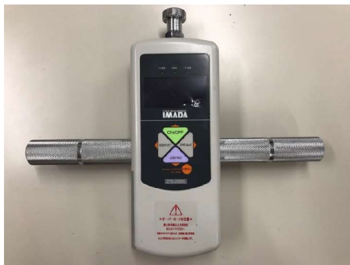
写真 4-12 使用したロードセル
