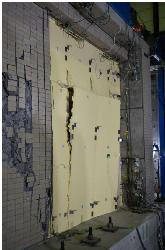
写真 5-11 セット 9 終了時の面外方向に変位した上張りボードの様子
