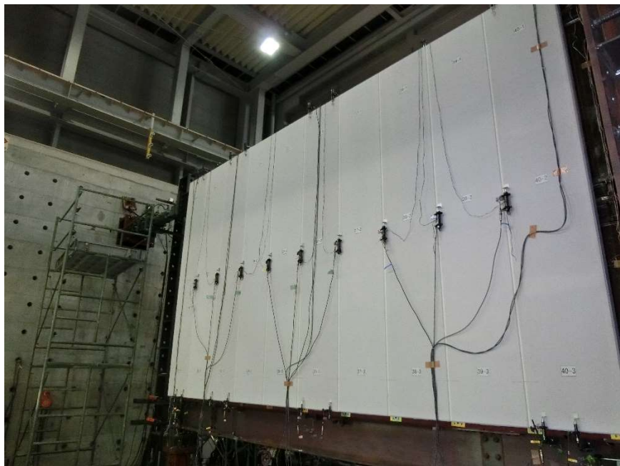
写真 4-5 東側（無開口の平坦な壁（壁 A））からの試験体外観
