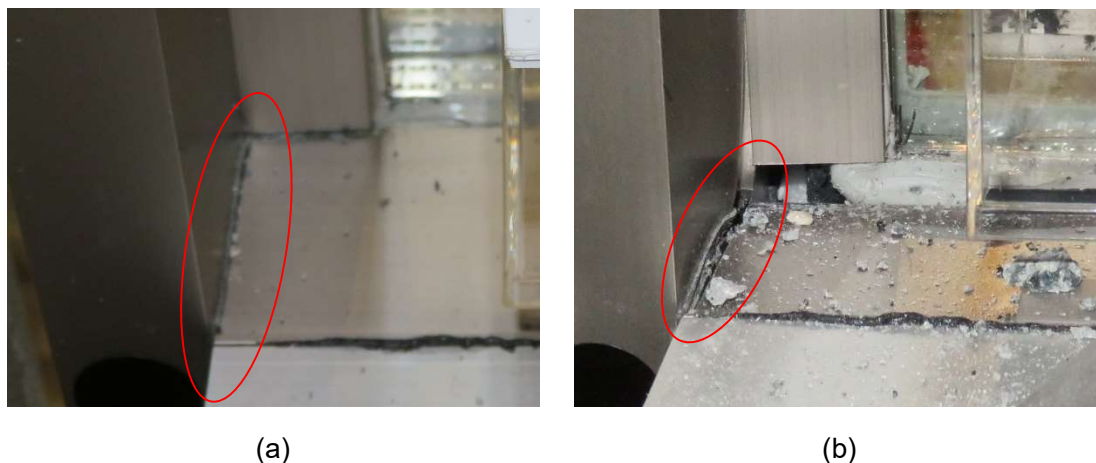
写真 5-23 2階のFIX窓の縦枠と下枠との間の隙間; (a) 150% (1回目) 加振後, (b) 160%加振後
