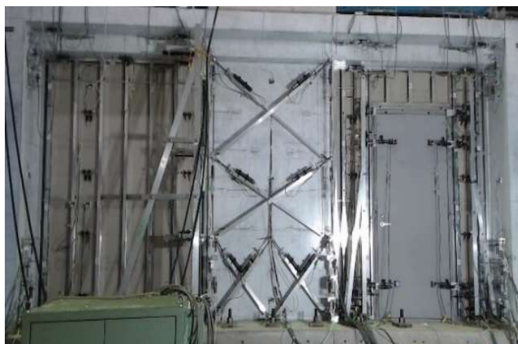
写真 4-11 南側（下地側）からの試験体外観
