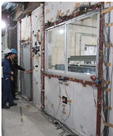
写真 4-9 開閉機能を確認している様子
